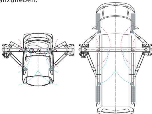
Dank der **Versymmetric® Technik** können sowohl Fahrzeuge mit kurzem (z.B. Smart) als auch solche mit langem Radstand (z.B. VW T5 lang) bequem angehoben werden.
